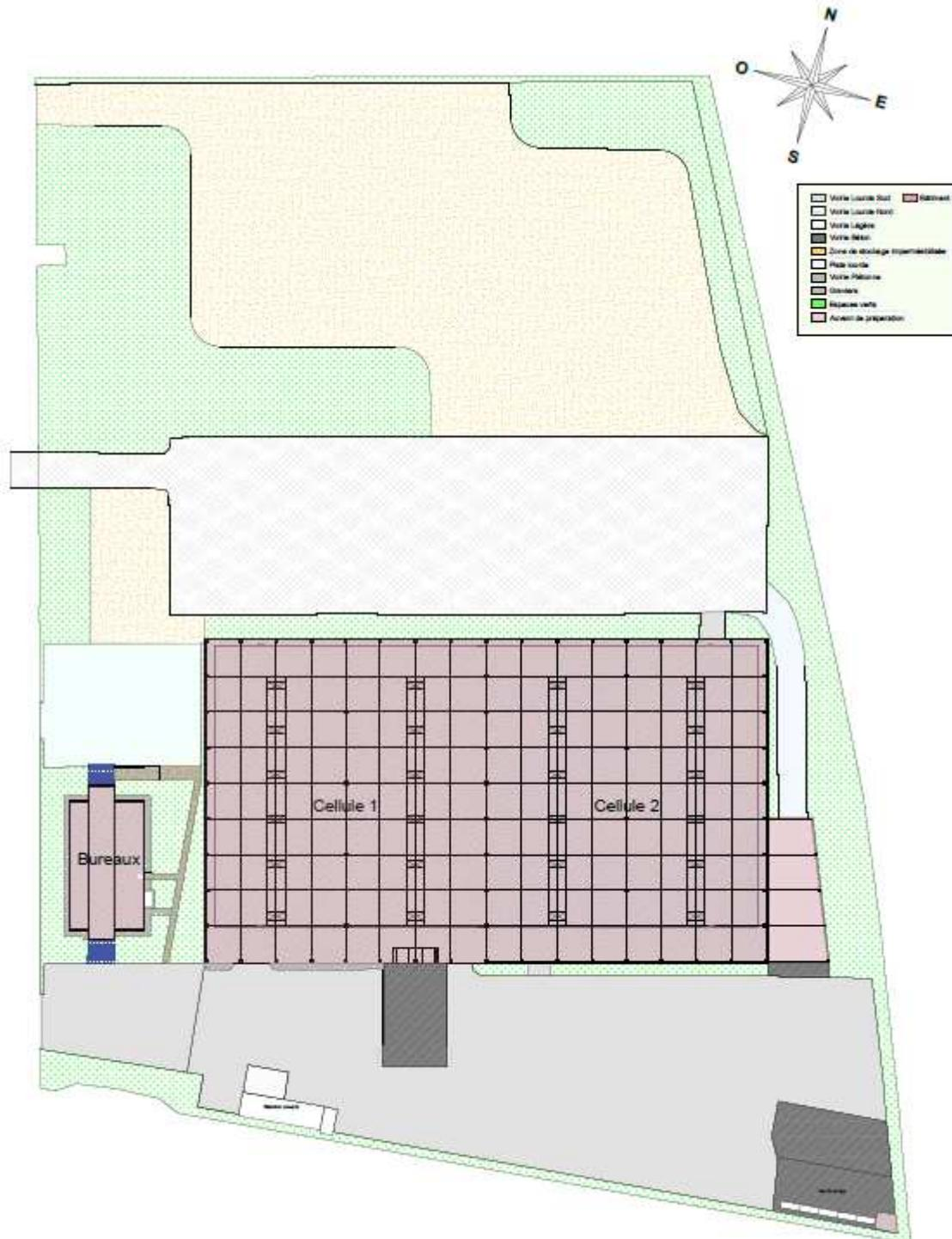
Les cellules sont disposées à une distance supérieure à 20 mètres du périmètre extérieur du site à l'exception de la façade Est de la Cellule 2 qui se situe au plus près à 10 mètres de la limite de propriété.
