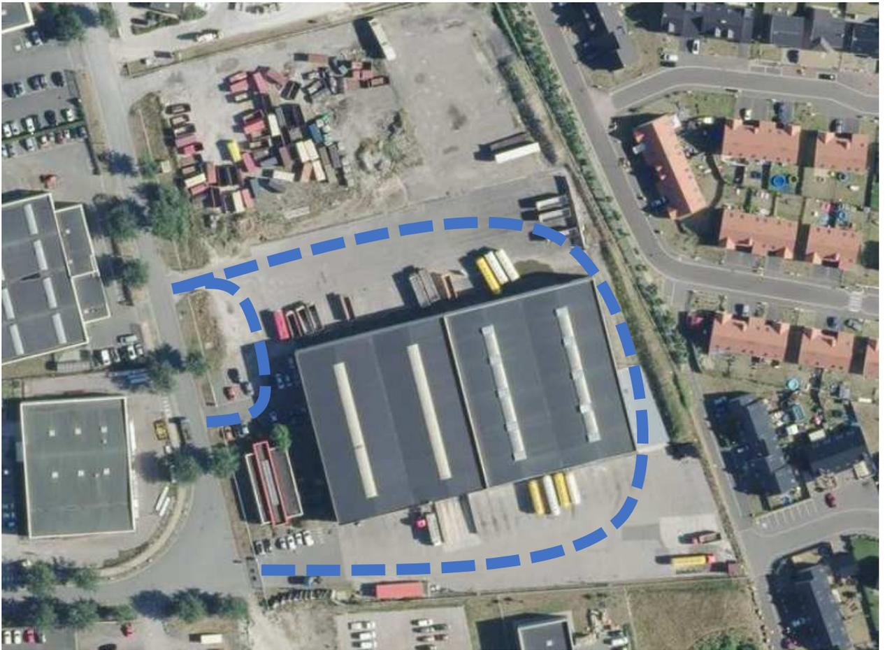
L'auvent à l'Est de la Cellule 2 permet d'effectuer les opérations de transit de marchandises à l'abri des intempéries. Aucun stockage n'y est toléré. Il dégage un gabarit aérien de 6,80 m permettant la circulation sans difficulté des engins pompiers.
