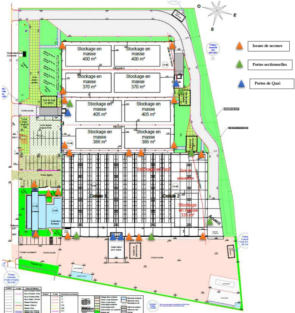
Les Cellules sont équipées de portes piétonnes ouvrant vers l'extérieur équipées de barres-anti-panique.
